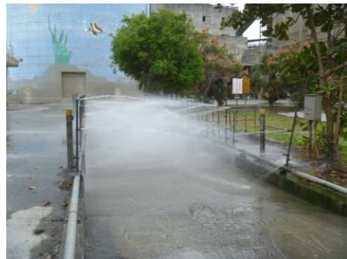
自動洗車設備
