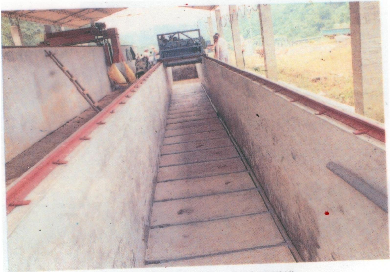
圖11 醱酵槽配合自動攪拌機構造
