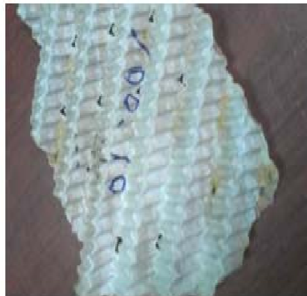
冷卻水塔附著髒污及漏水情形
