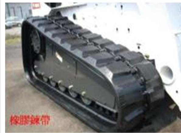
施工機具防音減振設備
