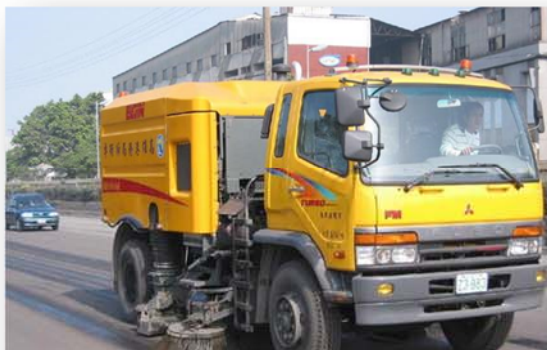
A. 掃街車功能 1. 吸塵方式：真空式。 2. 有效清掃範圍：2公尺。
