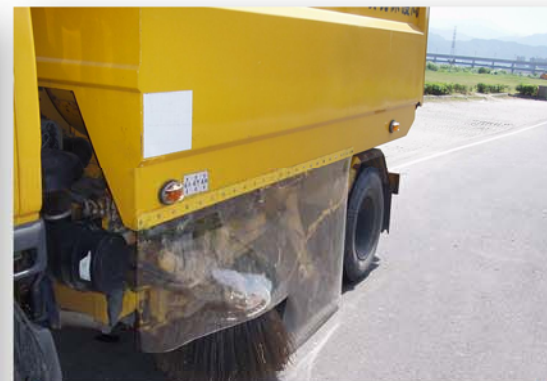
C. 掃刷作業區：應加裝阻隔設施，減少作業揚塵
