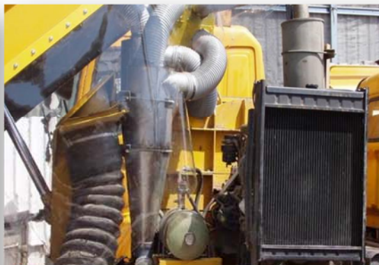
B. 吸塵氣流以防制設備除塵後，再排放至空氣中
