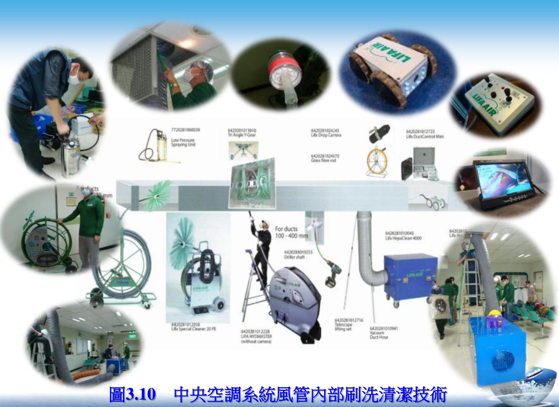
圖3.10 中央空調系統風管內部刷洗清潔技術
