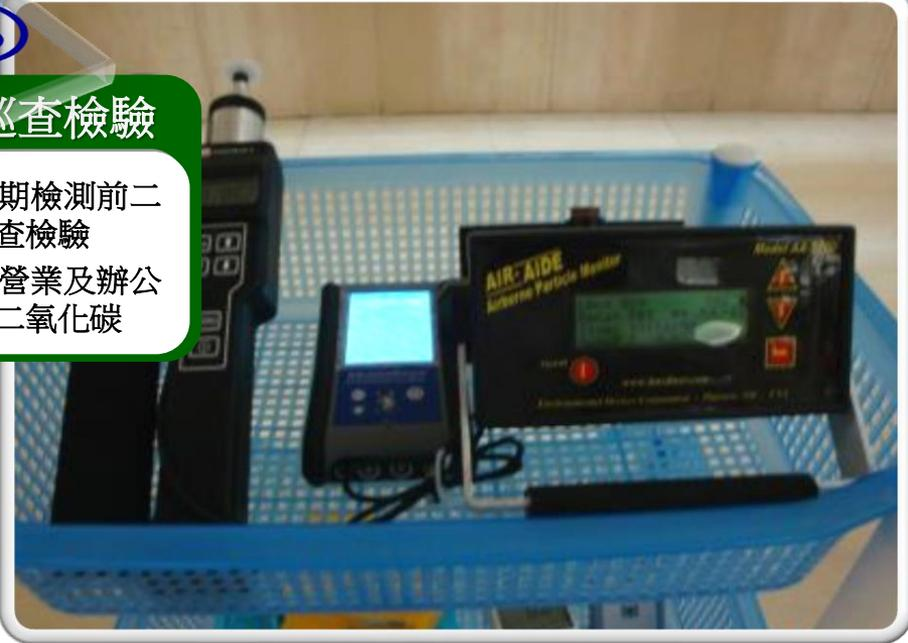
圖3-9 巡檢式檢測儀器測定室內空氣污染物之情形（置於工作車或平台）
