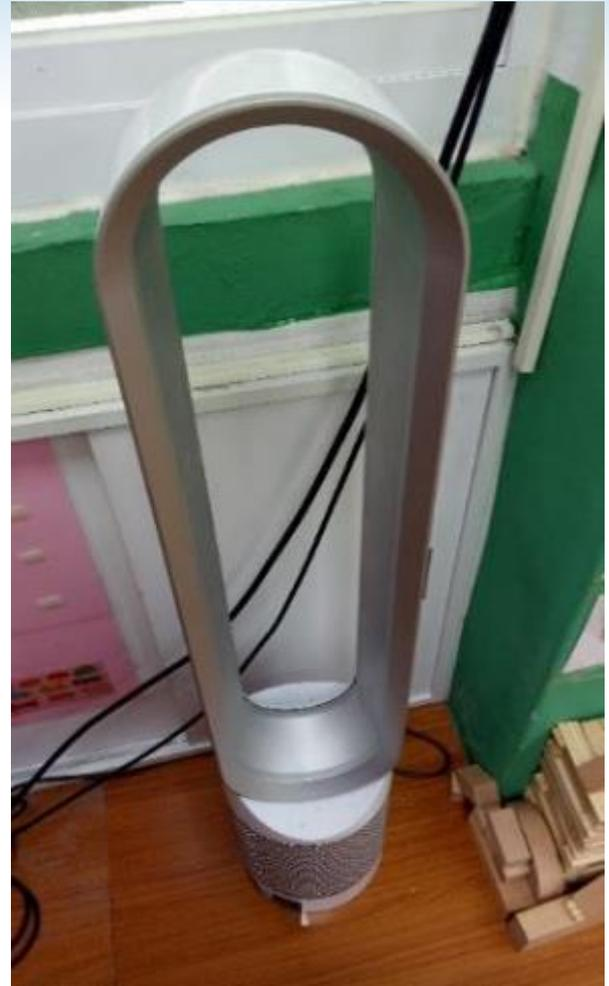
圖4-8 空氣淨化機放置角落或過於靠近物品而不利氣流循環與淨化(續)
