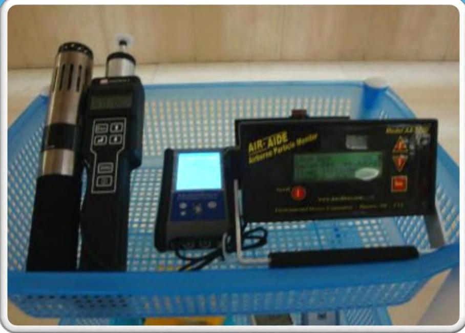
圖3.8 巡檢式檢測儀器測定室內空氣污染物之情形（置於工作車或平台）
