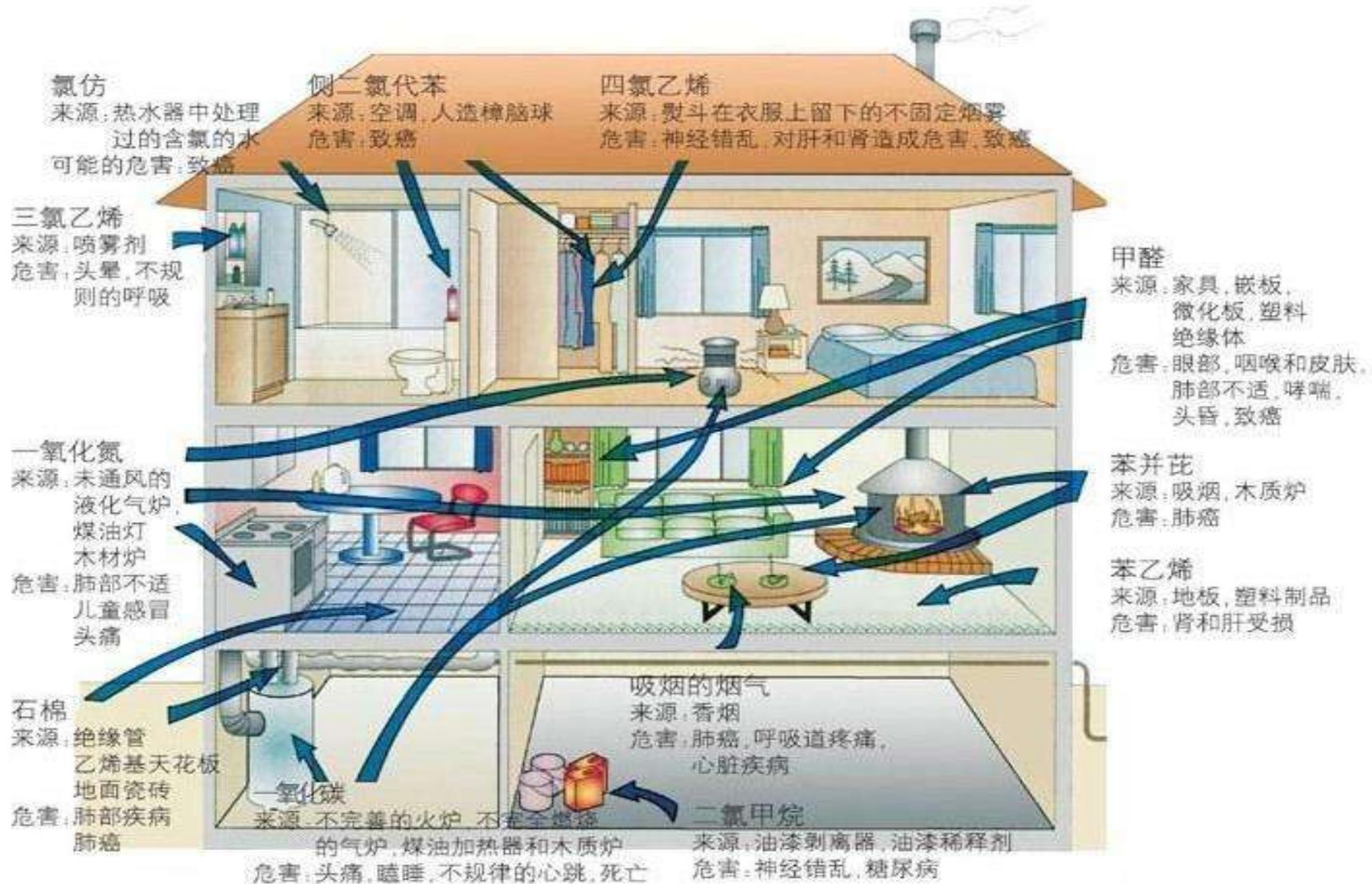
圖1.6 通風換氣不良的建築物可能存在多種室內空氣污染物質
