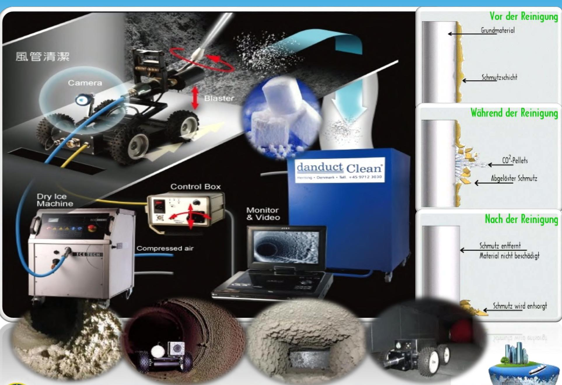
圖7.13 中央空調系統風管內部乾冰清潔技術
