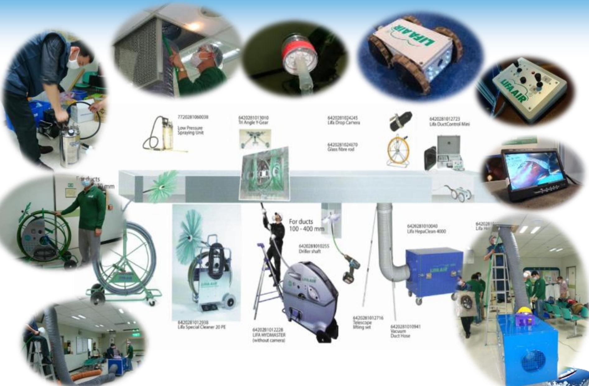
圖3.10 中央空調系統風管內部刷洗清潔技術
