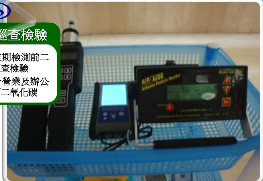
圖2-12 巡檢式檢測儀器測定室內空氣污染物之情形（置於工作車或平台）
