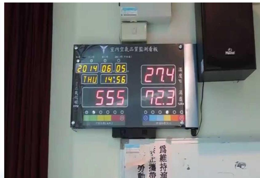
圖4-2 室內空氣品質二氧化碳連續監測設施顯示螢幕
