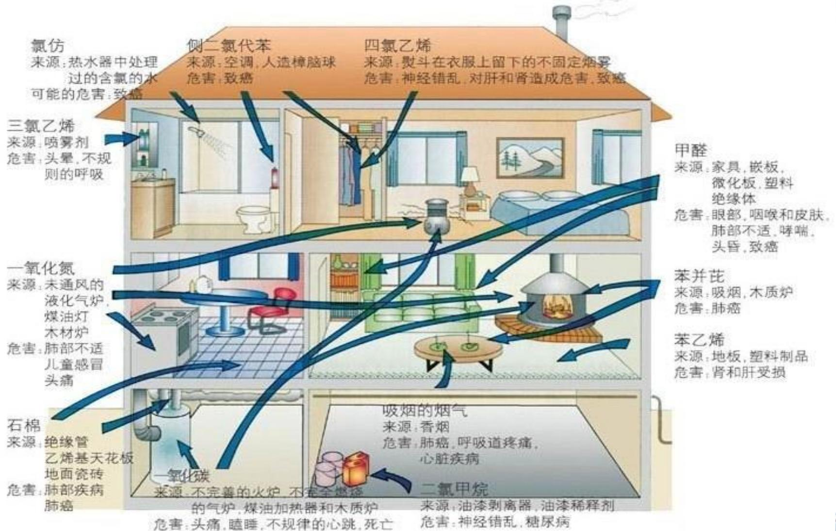
圖1.7 通風換氣不良的建築物可能存在多種室內空氣污染物
