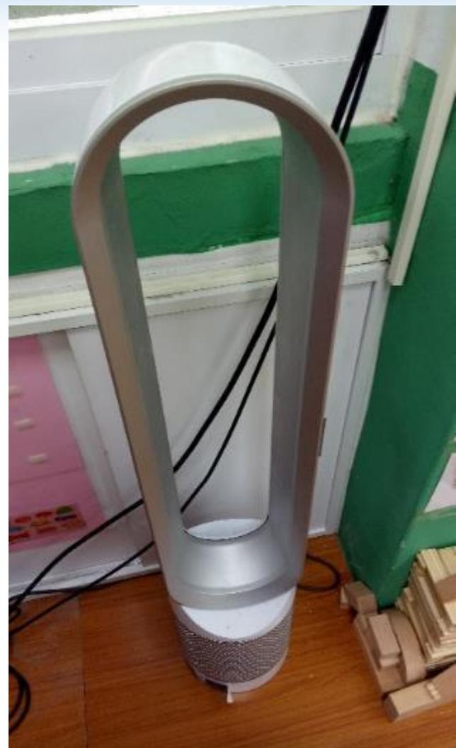
圖6.6 空氣淨化機放置角落或過於靠近物品而不利氣流循環與淨化(續)
