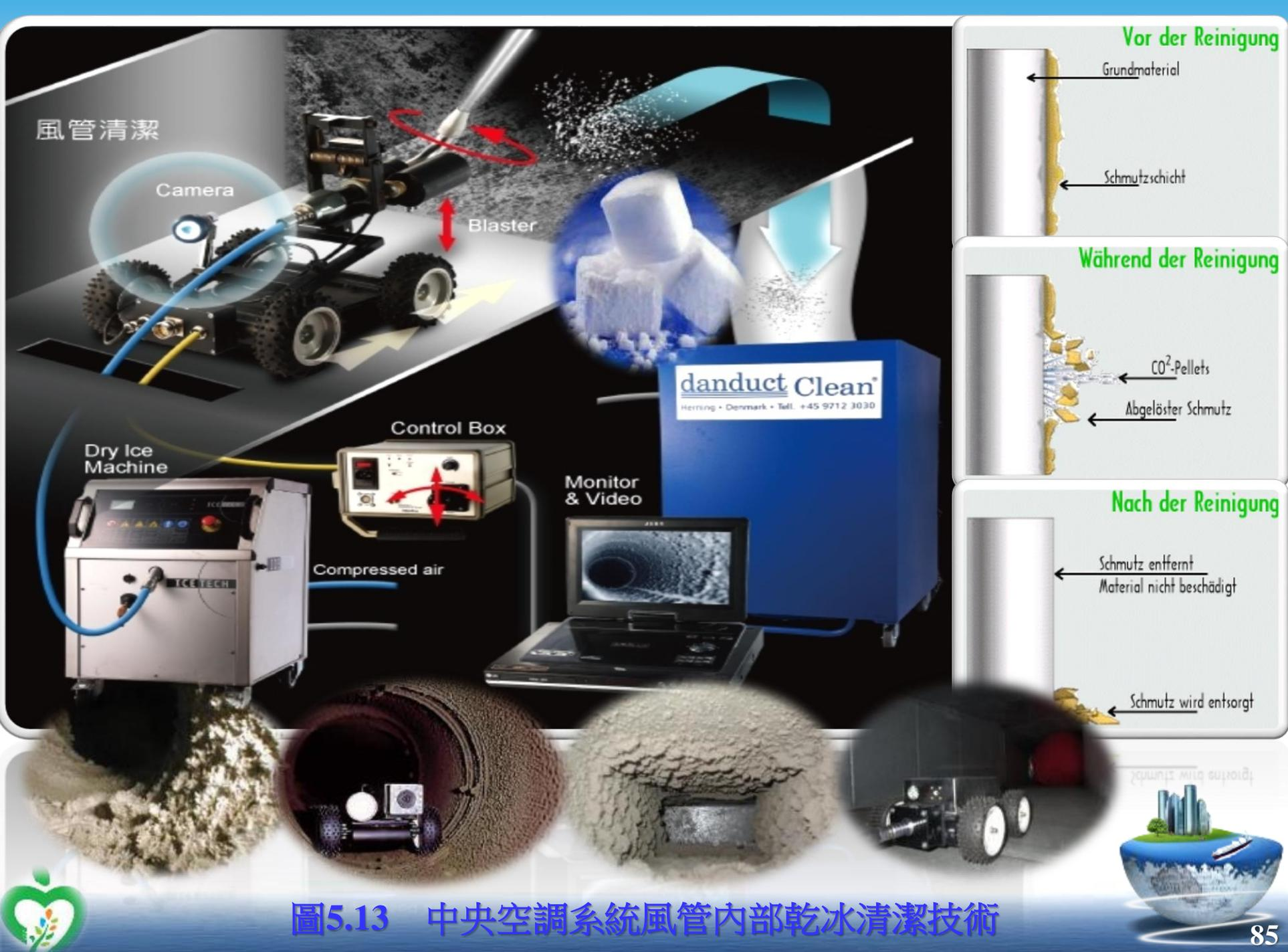
圖5.13 中央空調系統風管內部乾冰清潔技術
