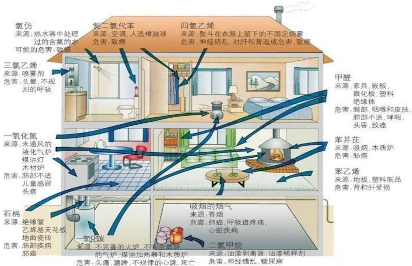
圖1.2 通風換氣不良的建築物可能存在多種室內空氣污染物
