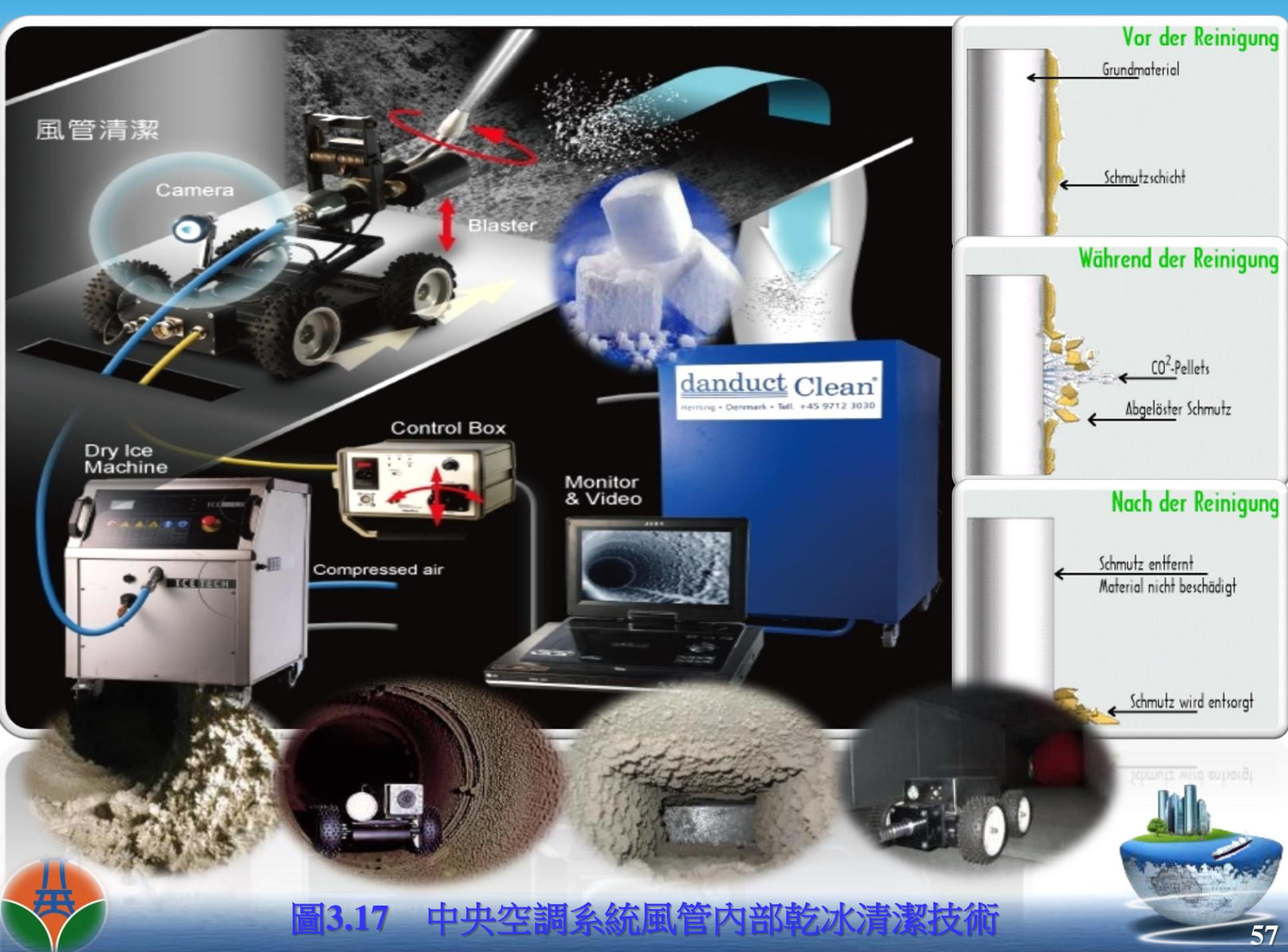
圖3.17 中央空調系統風管內部乾冰清潔技術
